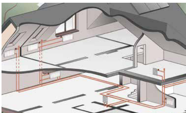
Układ „pionowy” instalacji grzewczej
