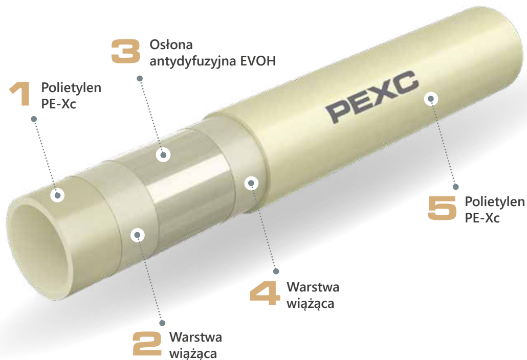
Przekrój rury PEXC z osłoną antydyfuzyjną
