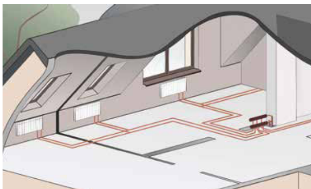
Układ rozdzielaczowo-trójnikowy w instalacji grzewczej
