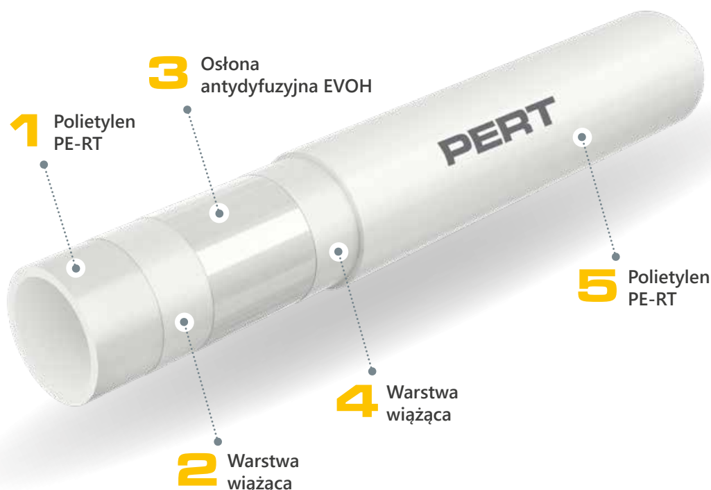
Przekrój rury PERT z osłoną EVOH
