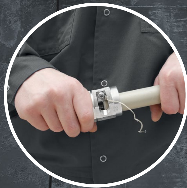
02 Usuwanie folii aluminiowej zdzierakiem (rury zespolone stabiAL PPR).
