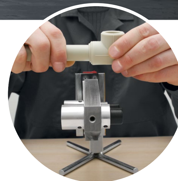
06 Unieruchomienie i chłodzenie połączenia.
